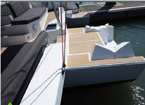
La plateforme destinée à l'annexe semi-rigide l'assurera bien mieux que des bossoirs. Le coffre à bib situé est au-dessous d'elle.
