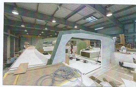
Les deux grandes cloisons en sandwich du Neel 51 sont structurelles, elles lui confèrent une remarquable raideur transversale.
